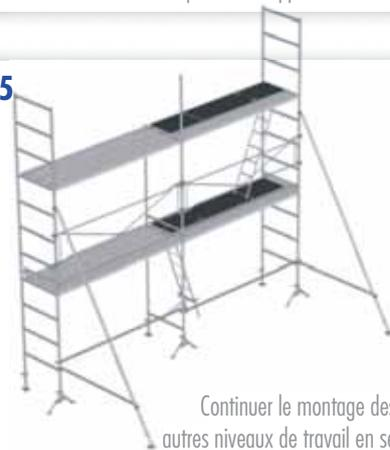
Continuer le montage des autres niveaux de travail en se référant au paragraphe 4. Terminer le dernier niveau de travail avec les cadres E1500B3 aux extrémités et les montants M1200 aux mailles intermédiaires.
