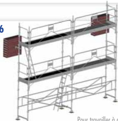
Pour travailler à des niveaux supérieurs, répéter les points 3 à 5. Pour le niveau supérieur, monter aux centres des échelles type « HL ». Amarrer l'échafaudage à la façade.
