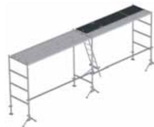
Placer les planchers fixes et le plancher à trappe, appuyer la première échelle d'accès sur le support.
