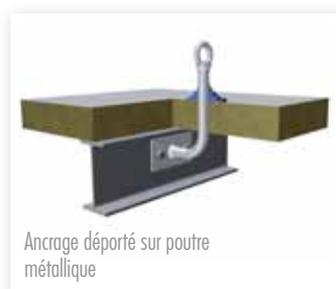
Ancrage déporté sur poutre métallique
