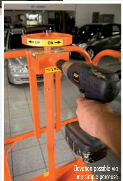
Elevation possible via une simple perceuse
