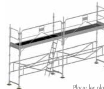
Placer les planchers fixes et les planchers d'accès en posant l'échelle d'accès sur le support. Compléter les protections en plaçant les plinthes latérales et longitudinales.
