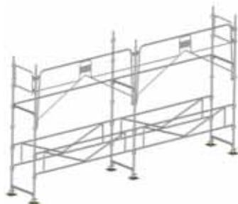
Installer les garde-corps montage et lisses dans la partie intérieure.
