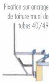
Fixation sur ancrage de toiture muni de tubes 40/49
