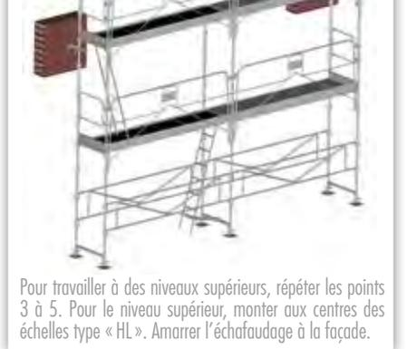
Pour travailler à des niveaux supérieurs, répéter les points 3 à 5. Pour le niveau supérieur, monter aux centres des échelles type « HL ». Amarrer l'échafaudage à la façade.
