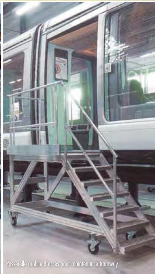
Passerelle mobile d'accès pour maintenance tramway
