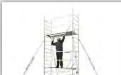
2. Rapide à mettre en place, le garde-corps pèse moins de 5 kg et ne comporte que 2 points de fixation.
