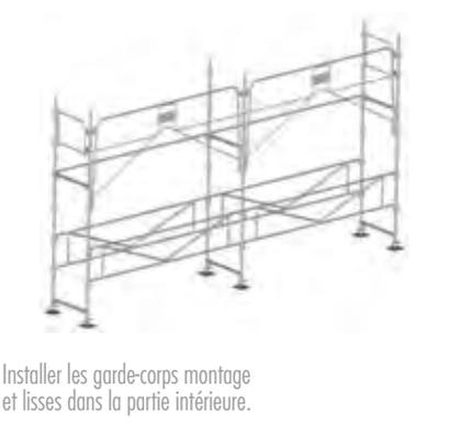
Installer les garde-corps montage et lisses dans la partie intérieure.
