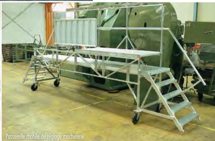
Passerelle mobile de réglage machinerie
