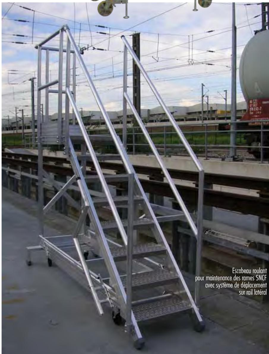
Escabeau roulant pour maintenance des rames SNCF avec système de déplacement sur rail latéral
