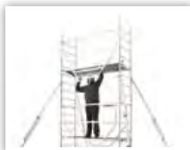
2. Rapide à mettre en place, le garde-corps pèse moins de 5 kg et ne comporte que 2 points de fixation.
