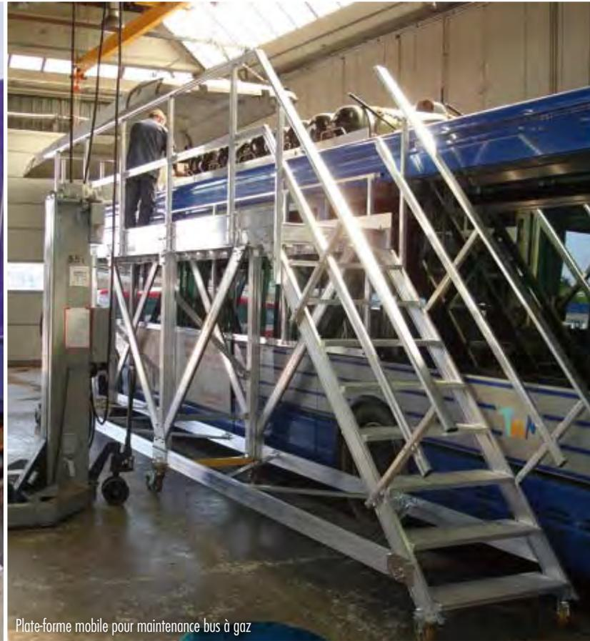
Plate-forme mobile pour maintenance bus à gaz
