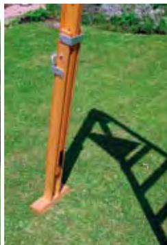
Pied d'appui télescopique avec traverse évitant l'enfoncement dans le sol
