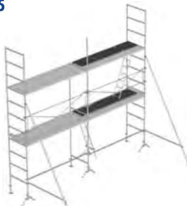
Continuer le montage des autres niveaux de travail en se référant au paragraphe 4. Terminer le dernier niveau de travail avec les cadres E1500B3 aux extrémités et les montants M1200 aux mailles intermédiaires.
