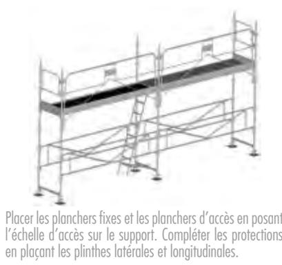
Placer les planchers fixes et les planchers d'accès en posant l'échelle d'accès sur le support. Compléter les protections en plaçant les plinthes latérales et longitudinales.
